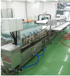
중,소형 생선(고등어, 삼치, 꽁치, 이면수등)을 자반용으로 활복하는 기능으로 활복기의 투입구 슈트쪽으로 생선을 투입하면 회전하는 원형칼에 의해서 아가미 하단부로 절개되며 회전하는 벨트에 의하여 자동으로 아웃슈트로 배출되는 설비임.
