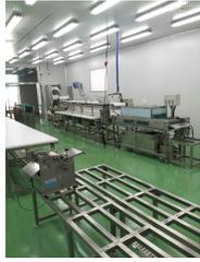
머리가 절단된 생선(고등어, 삼치, 꽁치, 이면수등)을 투입하면 내부에 장착된 원형칼에 의해 중간뼈와 살이 3매로 자동 분리된다. 좌,우살 부분은 컨베어 벨트에 의해 배출구로 이송이 되어 2단컨베어 작업대등의 다음 공정으로 이송되며, 종골인 뼈 부분은 하단의 슛터를 통하여 자연스럽게 배출이 된다. 생선의 중간뼈와 살이 자동으로 분리되는 기능임.
